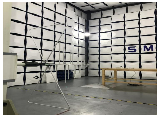
天线垂直辐射测试布置图
